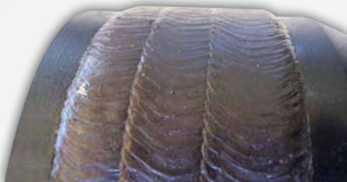
OTW10 Проволока для наплавки Hardbanding с повышенной износостойкостью, наносимой на замки
