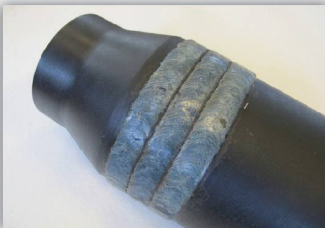
NCD ОТВ 12Ti, непосредственно после сварки
