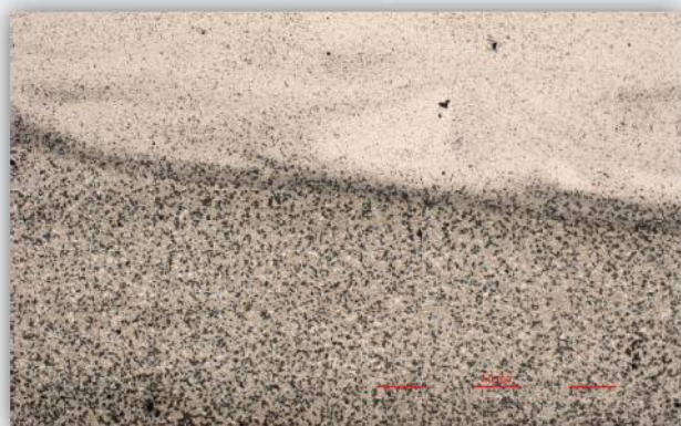
Граница проплавления между сплавом В конкурента и OTW 12Ti сверху
