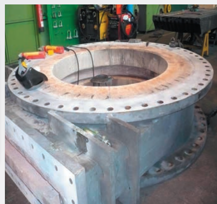
Воздушный клапан доменной печи (FAR 2891)
