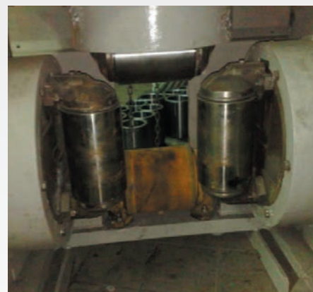
Ролики охлаждения для непрерывного литья (FAR 30938)
