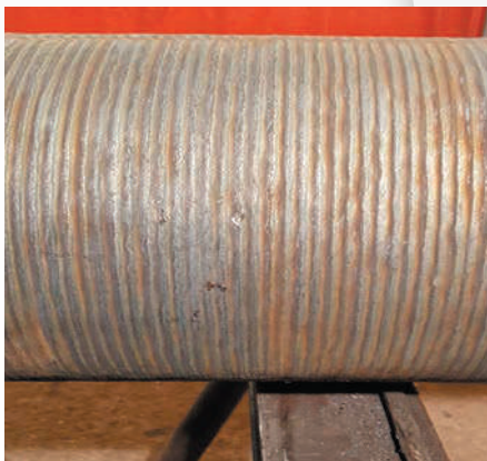
Охлаждающие ролики прокатного стана (FAR 29943)
