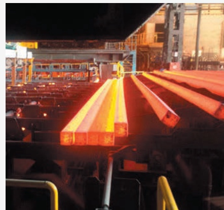
Стеллаж для охлаждения поступающих прутков (FAR 2850)
