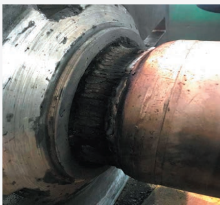
Отремонтированный волоочильный вал (FAR 26519)
