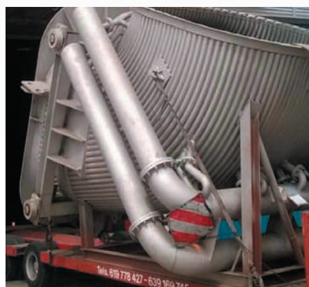
Выпускной газопровод (ES_M1_0432)
